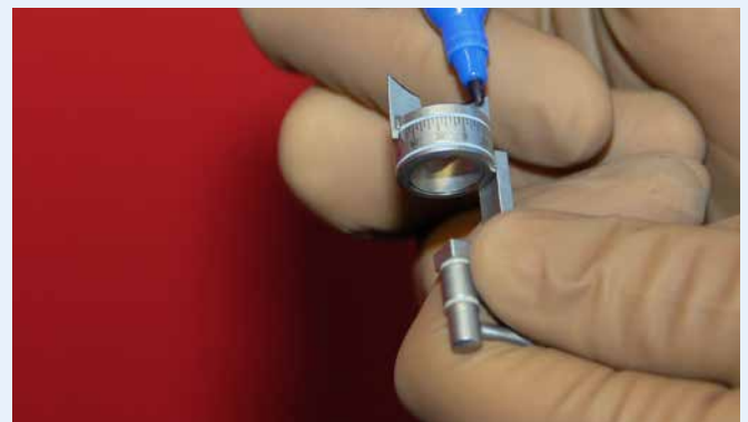
Vorbereitung des Markeurs für die Achsenmarkierung.
